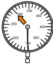
Das Kraftmessgerät ohne Last-Zeit-Diagramm (z.B. Kippstester) hat einen Kraftanzeiger, auf dem der Bediener die aufgebrauchte Kraft ablesen kann. Das Gerät verfügt über einen Schleppzeiger. Nach Beendigung der Kraftmessung bleibt der Zeiger bei der maximalen Belastung stehen. Alternativ kann über einen Signalton das Erreichen der geforderten Prüflast kontrolliert werden.
