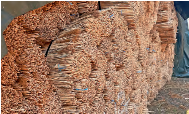
Das Reet wird in Bündeln geliefert, auf Dachlatten verteilt und mit Draht fixiert.
