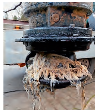
So sieht eine Verzopfung in einer Pumpe aus.
